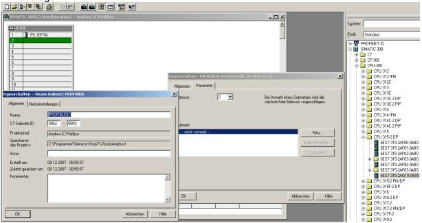
Markiert man nun das Profibus-Mastersystem, fügt ein Doppelklick auf "Anybus-IC DP-V0" im Bereich "weitere Feldgeräte > Allgemein" ein ABIC als Slave hinzu und öffnet sein Konfigurationsmenü. Nach dem Einstellen der Profibus-Adresse wird dieses Fenster geschlossen.
