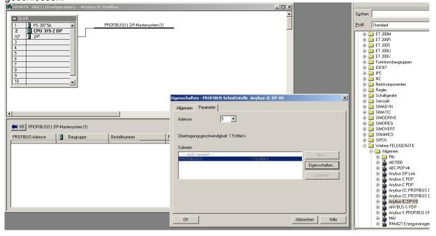
Sollte das ABIC noch nicht im Hardwarekatalog vorhanden sein, muss es über "Extras > GSD-Dateien installieren... hinzugefügt werden. Hierzu wird die GSD-Datei verwendet, die auf www.anybus.de im Supportbereich des ABIC für Profibus heruntergeladen werden kann.
